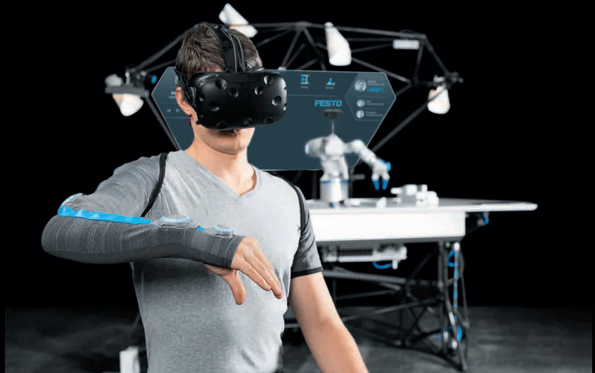
Kontrollierte Fernmanipulation: gefahrloses Arbeiten mit Hilfe der textilen Wearables und einer Virtual-Reality-Brille aus sicherer Distanz.
