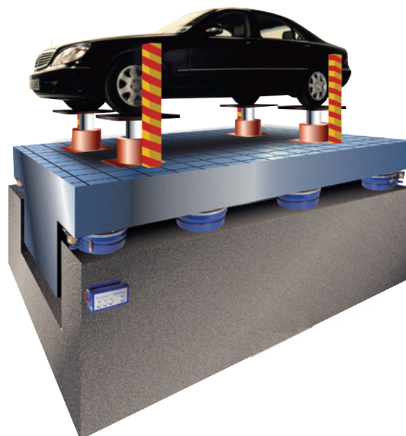
Prüfstände, Beispiel Straßensimulationsprüfstand
