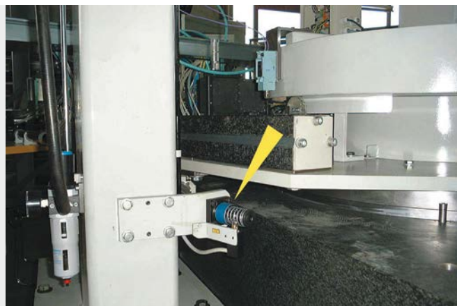
Optimal gesicherter Drehtisch
