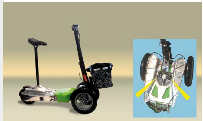
Strukturdämpfer erhöhen Fahrkomfort eines Elektro-Scooters
