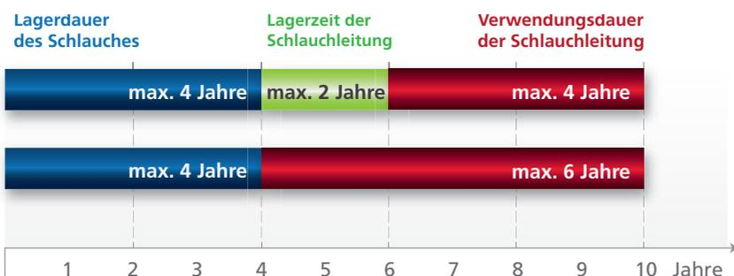
**Info: Sobald ein Schlauch mit einer Armatur verpresst wird, wird aus ihm eine Schlauchleitung!**
