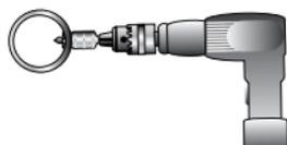
1. Bohren Sie mit Hilfe des Kronenbohrers Ref. **EW09 00 30**, **EW09 00 51** oder **EW09 00 64** an der gewünschten Position in das Aluminiumrohr.
