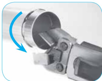
Öffnen Sie die beiden Pressbacken und entnehmen Sie das Rohr. Drehen Sie das Rohr leicht.
