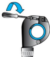
**4.** Ziehen Sie die Schraubenmutter mit einem Inbusschlüssel Hex 5 mm oder Hex 3/16" fest.
