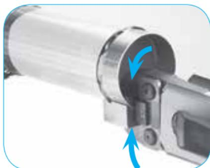
Lösen Sie die Pressbacken. Betätigen Sie den Schalter und bördeln Sie das Rohr, solange bis Sie ein Schlaggeräusch hören.
