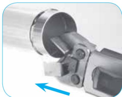
Öffnen Sie die 2 Pressbacken manuell. Legen Sie das Aluminiumrohr soweit wie möglich in die Presse ein.
