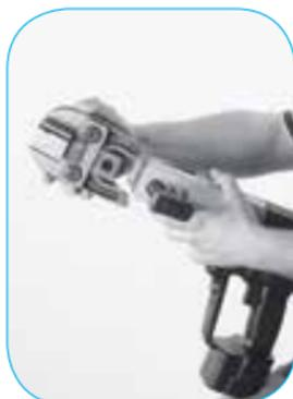
Setzen Sie die Pressbacke in das Gehäuse.
